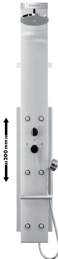
Lift 2 Showerpanel® душевая панель верхний душ Raindance S 180 Air 1jet ручной душ Axor Uno 3jet 6 боковых форсунок термостат регулируется по высоте в пределах 200 мм # 26871, -000
